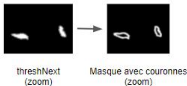
FIGURE 14 – Obtention du masque contenant les couronnes des cnts par soustraction de threshNext dilatée 2 fois avec threshNext érodée 2 fois
